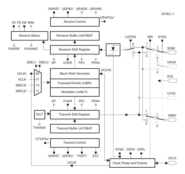
Figure 14-1. USART Block Diagram: SPI Mode
